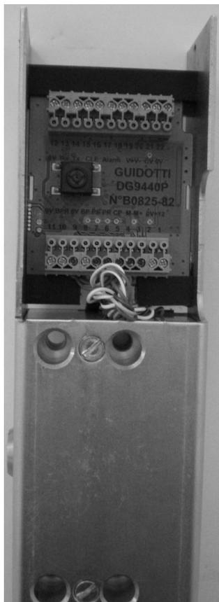
Pour faciliter le raccordement et le paramétrage de la serrure, via le bouton de programmation se trouvant sur l'interface de gestion, il est indispensable que les connecteurs soient dirigés vers l'installateur.
