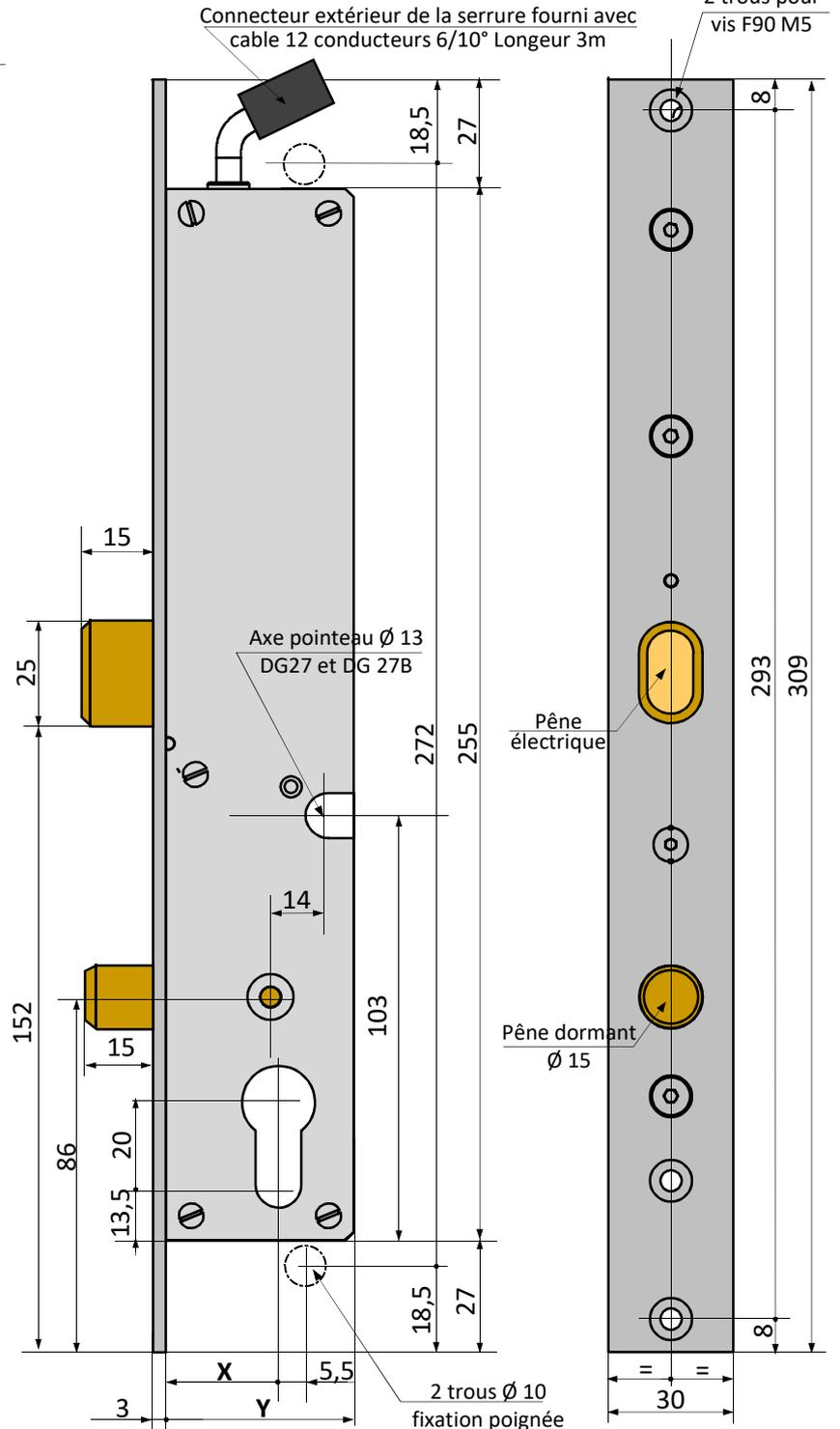
**X=50 ; Y=68 pour DG270IB et DG270CB**
